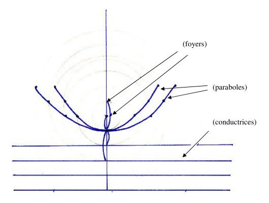
En bas à droite de l'original de Léonardo da Vinci nous trouvons le schéma suivant. Il prouve nos affirmations quant à l'étude du miroir parabolique par Léonardo da Vinci. Il montre aussi que ce dernier interprétait bien à la manière d'Apollonius, la parabole comme la section d'un cône par un plan parallèle à la pente de celui-ci.
